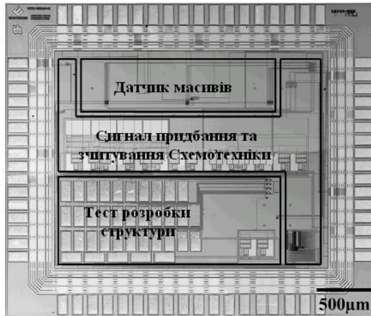
Рис. 8. Інтегральна схема з матрицею сенсорів
